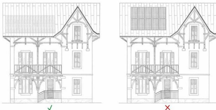
Insertion de panneaux photovoltaïques
